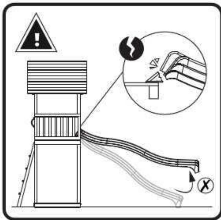
**Achtung:** das untere Ende der Rutsche darf nach erfolgter Montage **nicht angehoben** werden (beispielweise beim Rasenmähen)!
